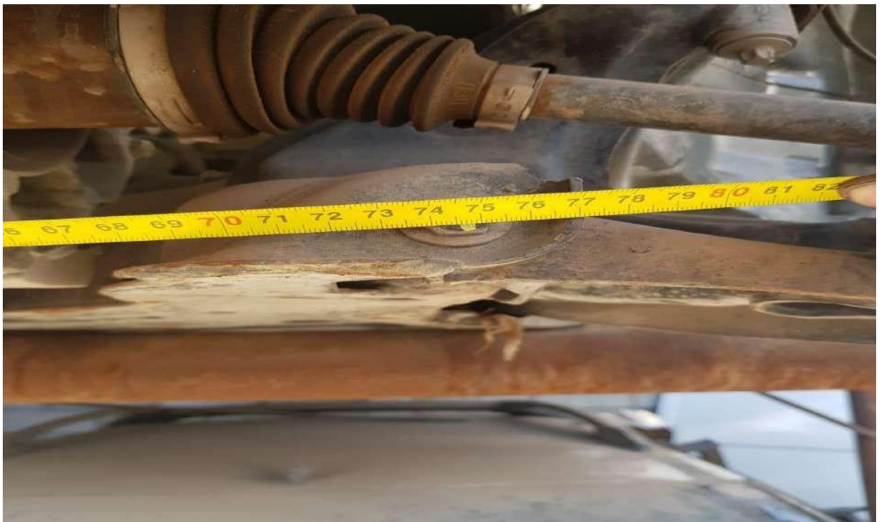
MEDIDA ANCLAJE DE CUNA DE MOTOR (ANCHO DE PARRILLA A PARRILLA 745 MM).
