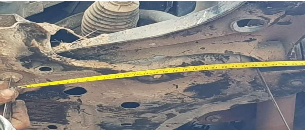
MEDIDA DE ANCHO CUNA DE MOTOR CENTRO A CENTRO SUJECCION DE LARGUERO DE CARROCERIA (930 MM).
