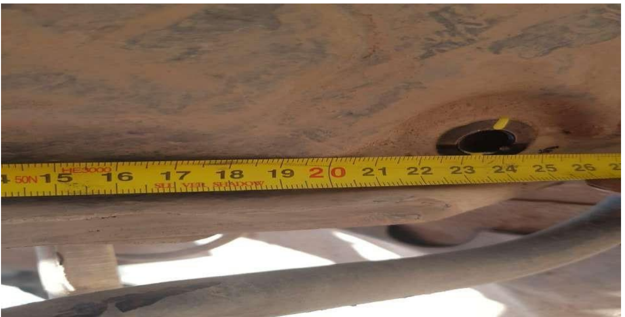
MEDIDA ANCLAJE PARRILLA DE SUSPENSION (240 MM).
