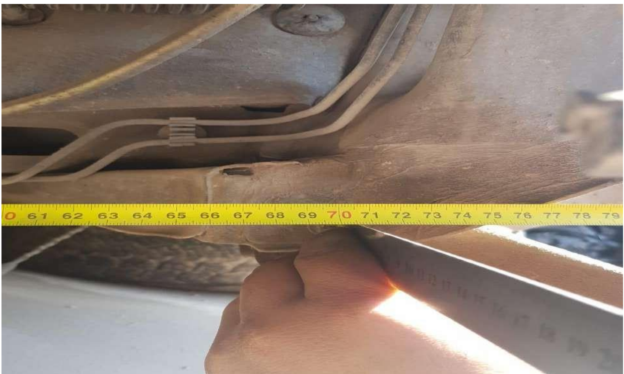
MEDIDA DE ANCHO CUNA DE MOTOR CENTRO A CENTRO SUJECCION DE LARGUERO DE CARROCERIA (705 MM).
