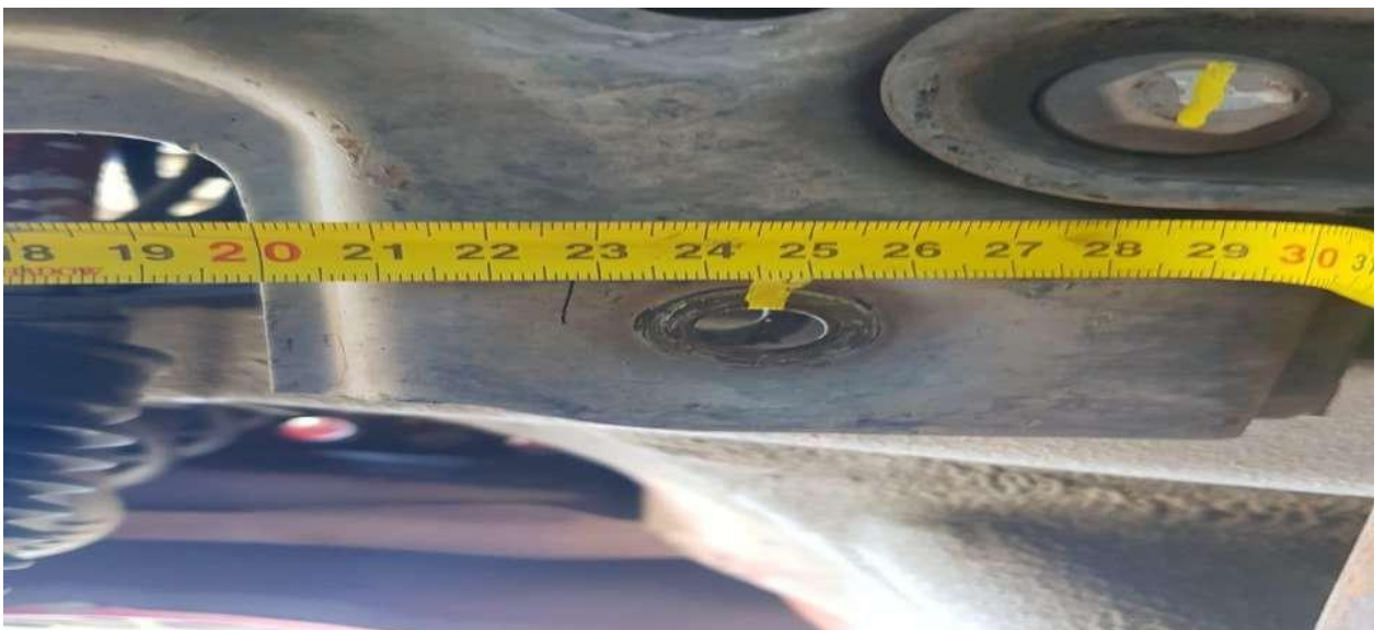
MEDIDA ANCLAJE PARRILLA DE SUSPENSION (245 MM).
