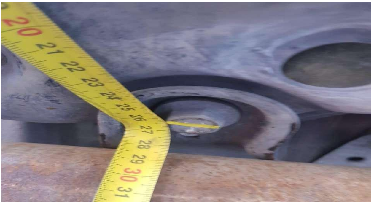
MEDIDA ANCLAJE DE CUNA DE MOTOR (LARGO LADO PARRILLA 265 MM).
