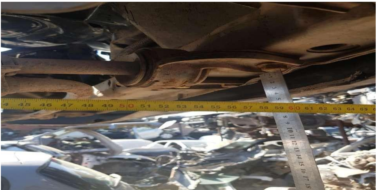
MEDIDA LARGO DE ANCLAJE DE BRAZO PARRILLA DE SUSPENSION A FRENTE INFERIOR DE CARROCERIA (600 MM).
