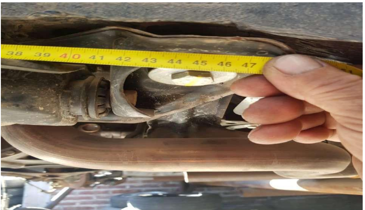
MEDIDA DE ANCLAJE DE CUNA DE MOTOR (LARGO LADO PARRILLA 453 MM).
