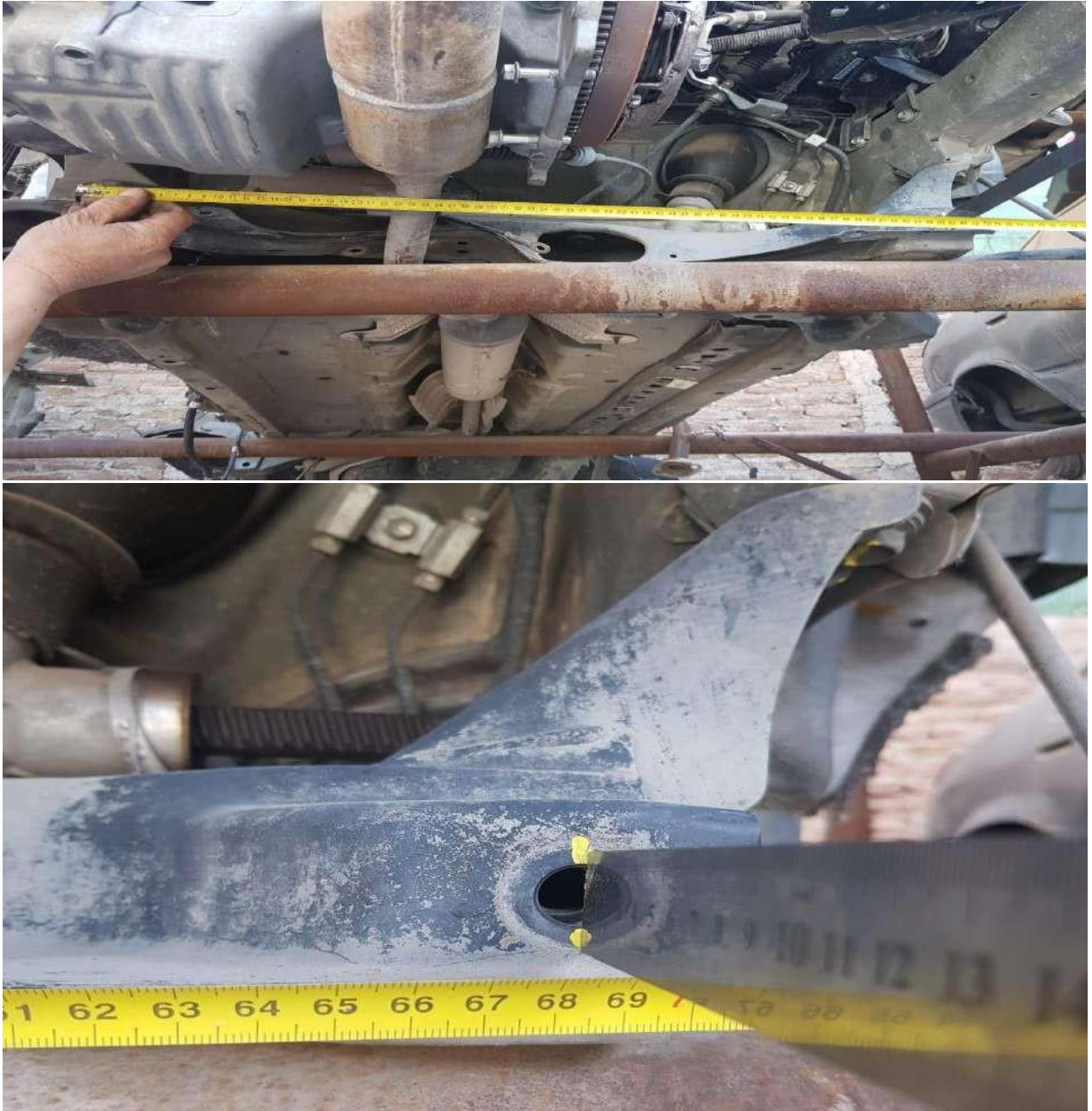
MEDIDA ANCLAJE DE CUNA DE MOTOR (ANCHO DE PARRILLA A PARRILLA 690 MM).
