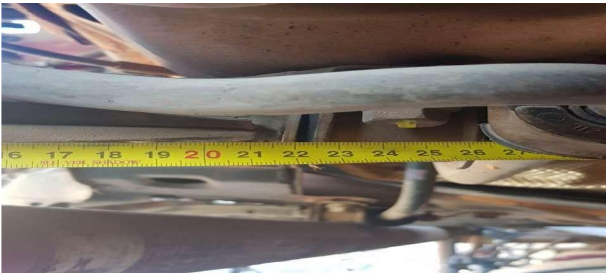
MEDIDA LARGO ANCLAJE CUNA DE MOTOR A CARROCERIA (245 MM).
