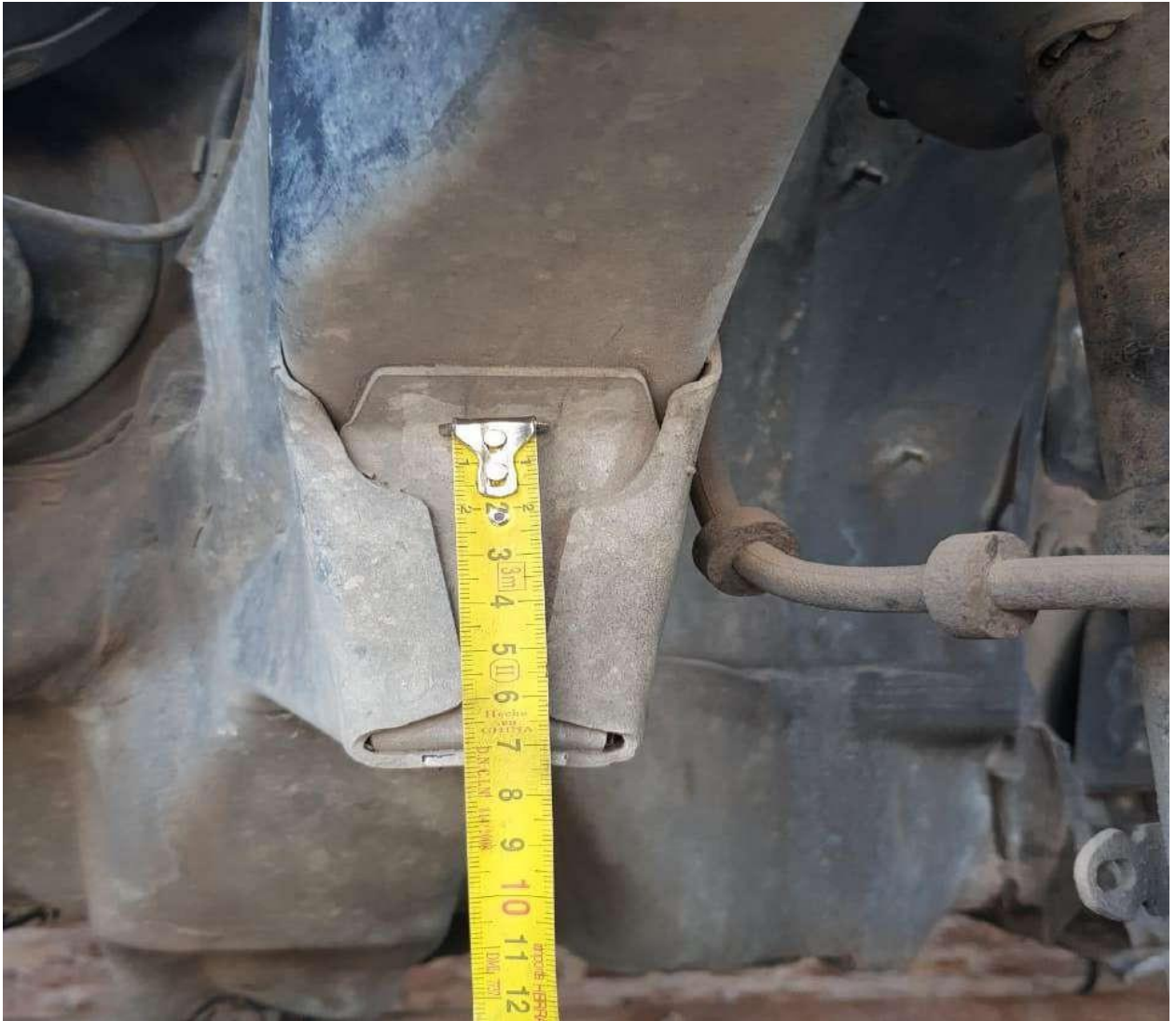
MEDIDA ANCLAJE DE BRAZOS DE CARROCERIA A CUNA DE MOTOR (74 MM)
