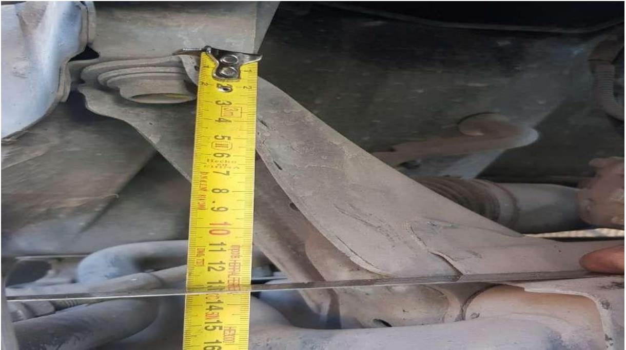
MEDIDA DE BRAZOS CUNA DE MOTOR A ANCLAJE DE CARROCERIA (130MM).
