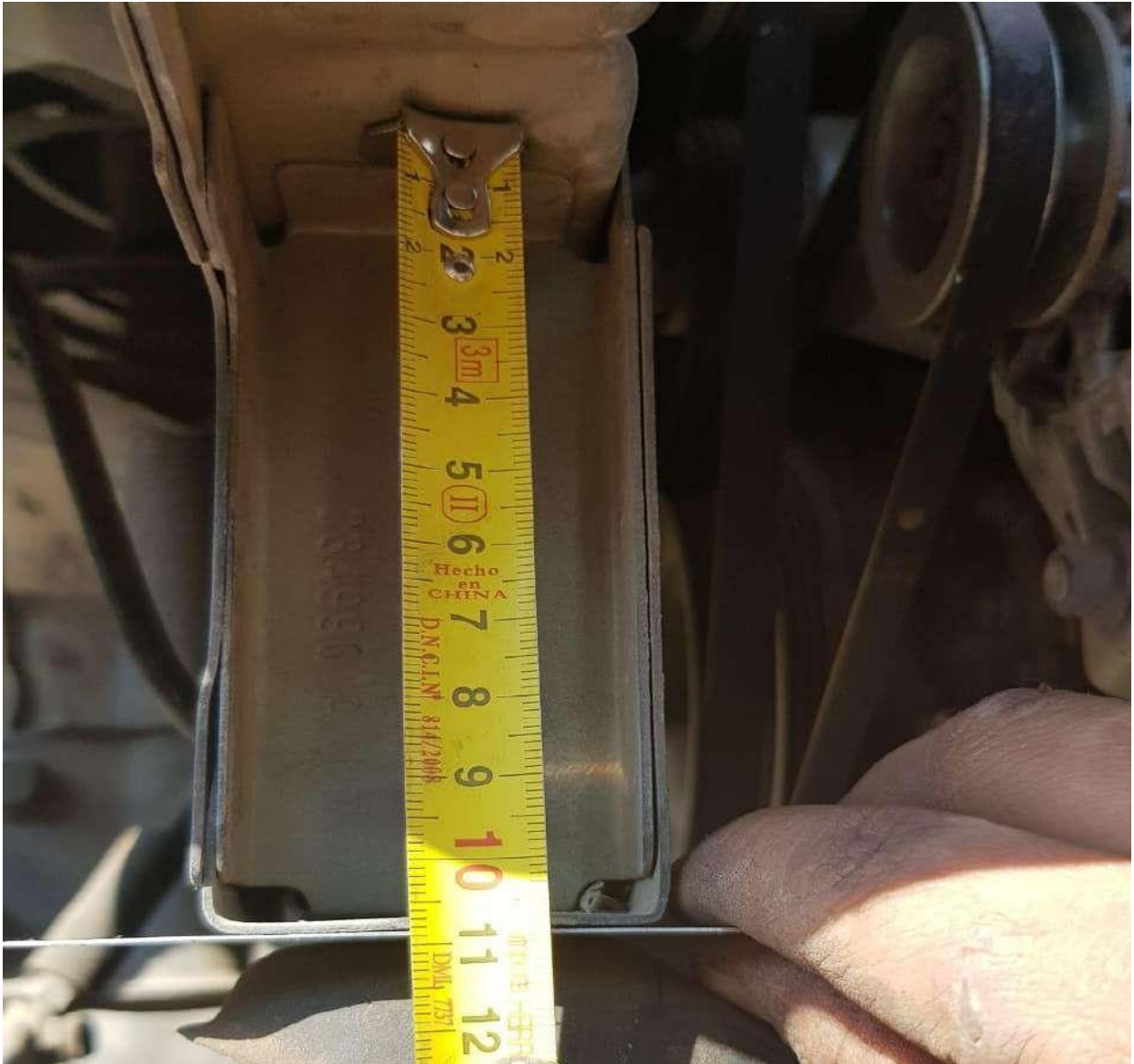
MEDIDA ANCLAJE DE BRAZOS DE CARROCERIA A CUNA DE MOTOR (109 MM).
