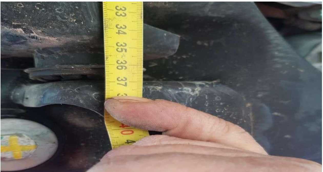
MEDIDA ANCLAJE PARRILLA DE SUSPENSION (370 MM).
