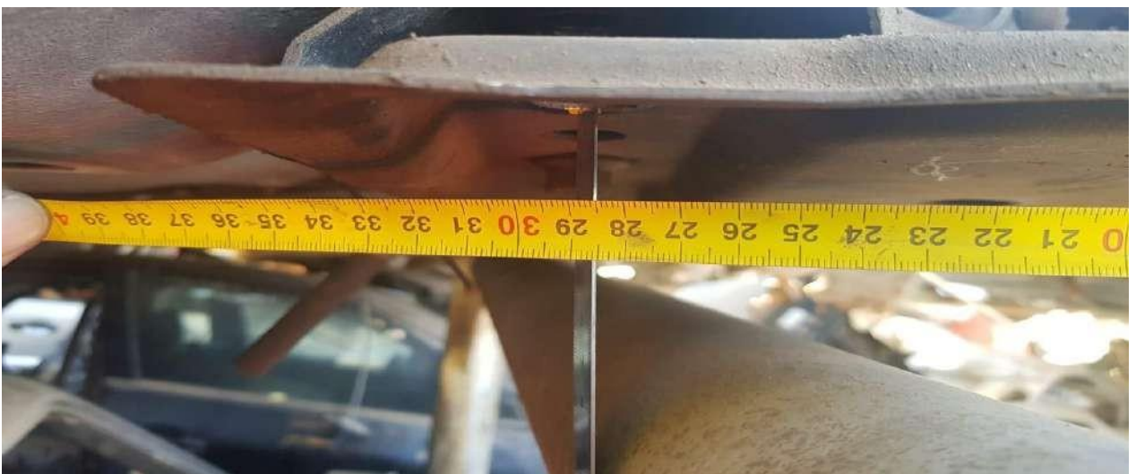
MEDIDA ANCLAJE PARRILLA DE SUSPENSION (285 MM).
