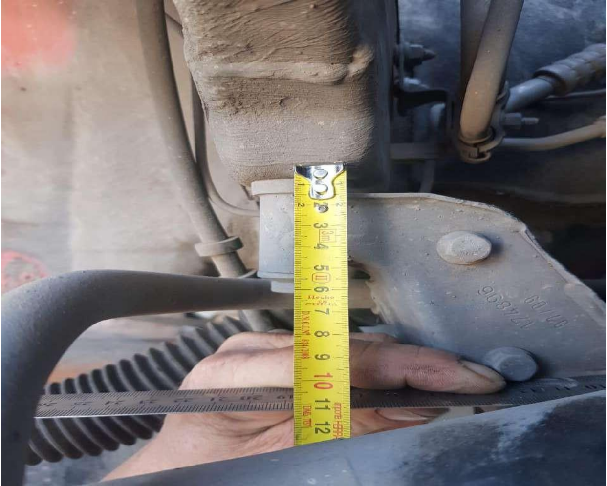
MEDIDA DE BRAZOS CUNA DE MOTOR A ANCLAJE DE CARROCERIA (110MM)
